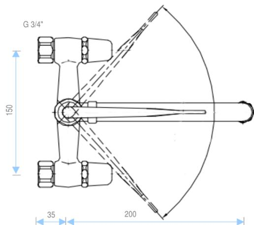
**Labor Armhebel Wandmischbatterie für Trinkwasser**
