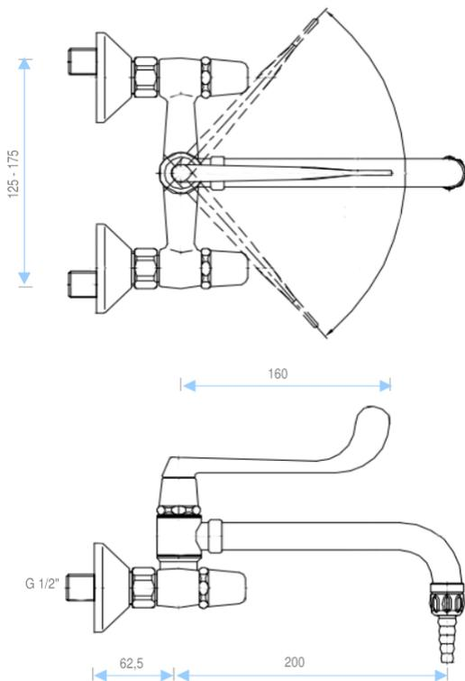
**Labor Armhebel Wandmischbatterie für Trinkwasser**
